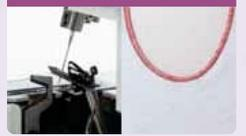
Contrairement aux modèles conventionnels, la distance entre l'aiguille et le couteau a été ramenée à 9,95 mm ! (modèle conventionnel: 15,5 mm). Cela vous autorise des courbes magnifiques avec un rayon plus petit.
