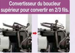
La présence d'un commutateur permet de passer facilement le boucleur supérieur en 2 ou 3 fils.
